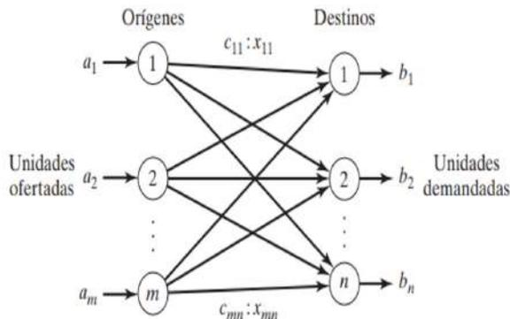
Figura 4.1. Representación del modelo de transporte con nodos y arcos.
