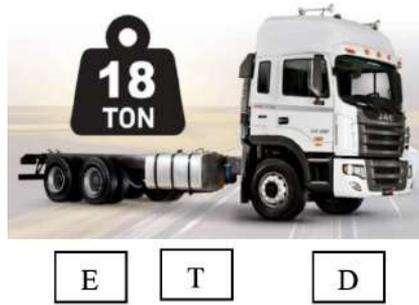
Figura 4.14. Tipos de neumáticos: D (Direccional), T (Tracción) y EL (Ejes libres).
